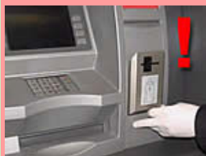
Okienko wrzutowe z założonym dodatkowym czytnikiem kart
